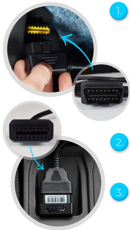
1. Insérez l'extrémité ouverte du câble d'extension, avec les broches de contact visibles, dans l'interface OBD de votre véhicule jusqu'à ce qu'elle s'enclenche.
