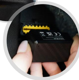
2. Inserire il Salind 08 4G nell'interfaccia OBD finché non si incastra.
